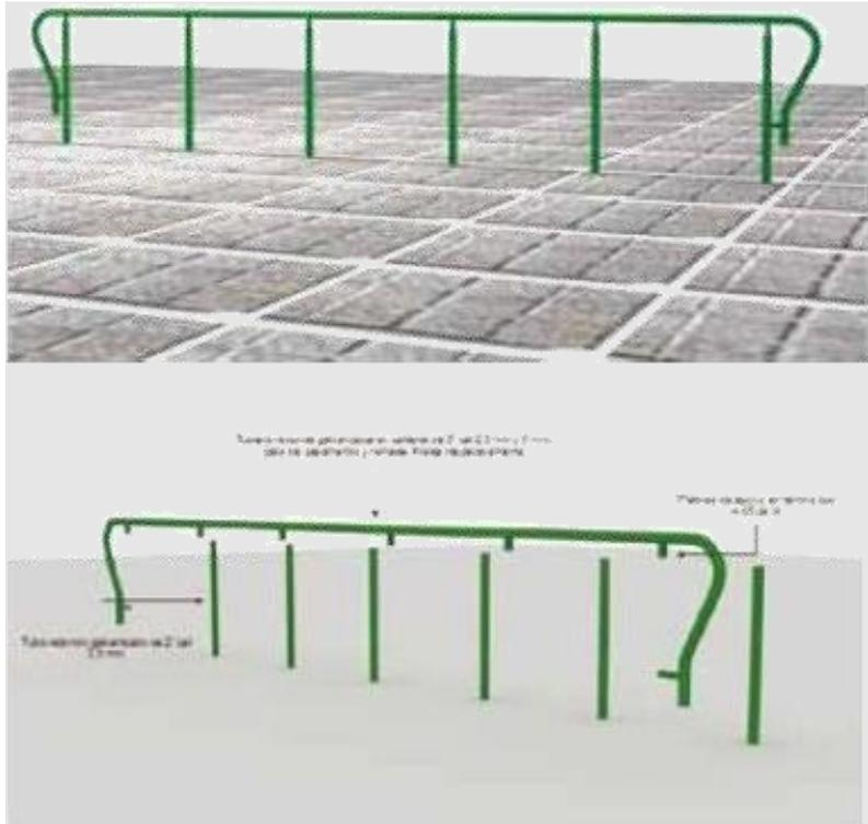
Elemento metálico elaborado en tubería redonda estructural, galvanizada en caliente, con diámetro nominal de 3" cal 2.5 mm y en cal 3 mm, para los remates curvados llamados corbatines. Los parales estarán distanciados cada 1000 mm entre centros y serán fabricados, en tubo redondo galvanizado de 2" nominal cal 2.5 mm.
