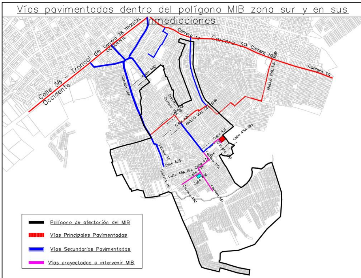
Ilustración 35. Vías principales pavimentadas, vías secundarias pavimentadas y vías proyectadas a intervenir con el proyecto MIB, dentro del polígono de intervención.
