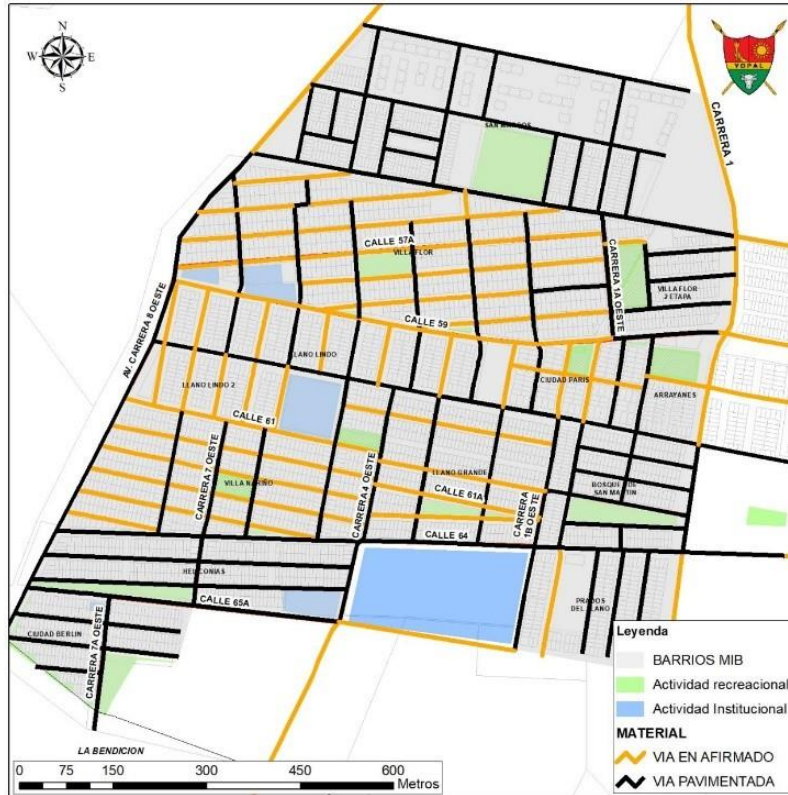
Ilustración 28. Estado de la malla vial en el área de intervención.
