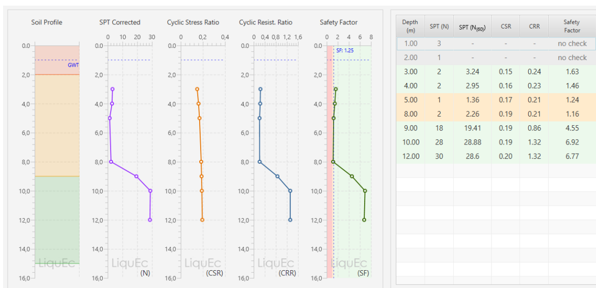
Figura 10. Análisis licuación perforación 14
