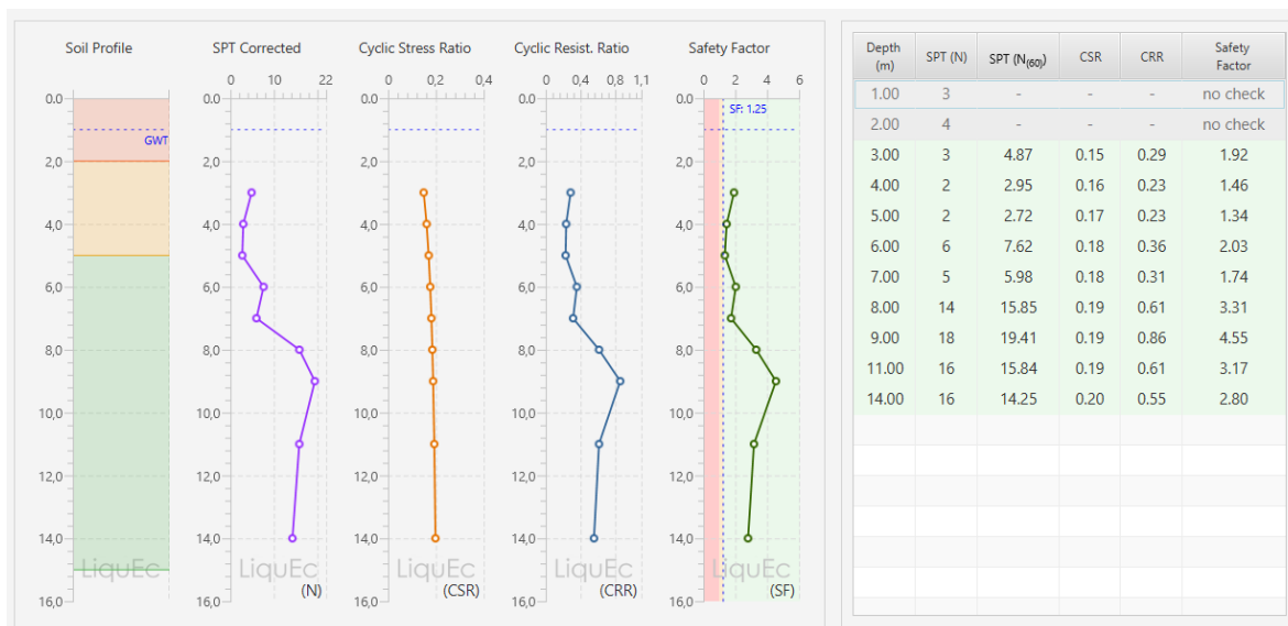
Figura 9. Análisis licuación perforación 11
