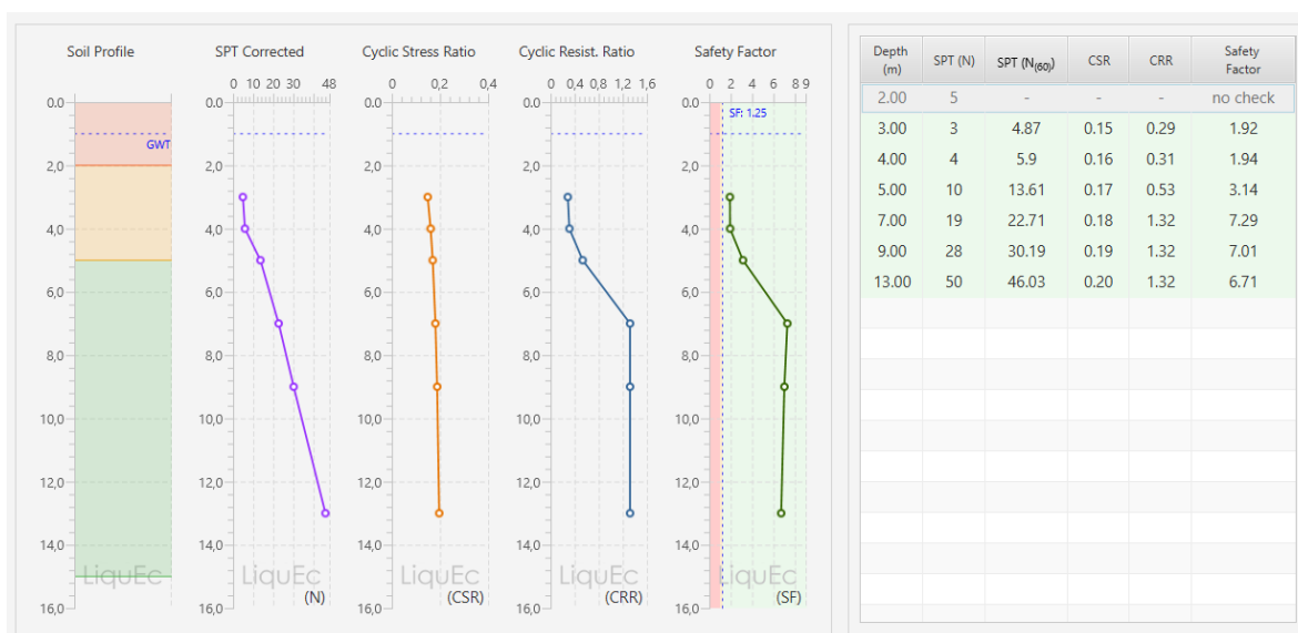
Figura 8. Análisis licuación perforación 9
