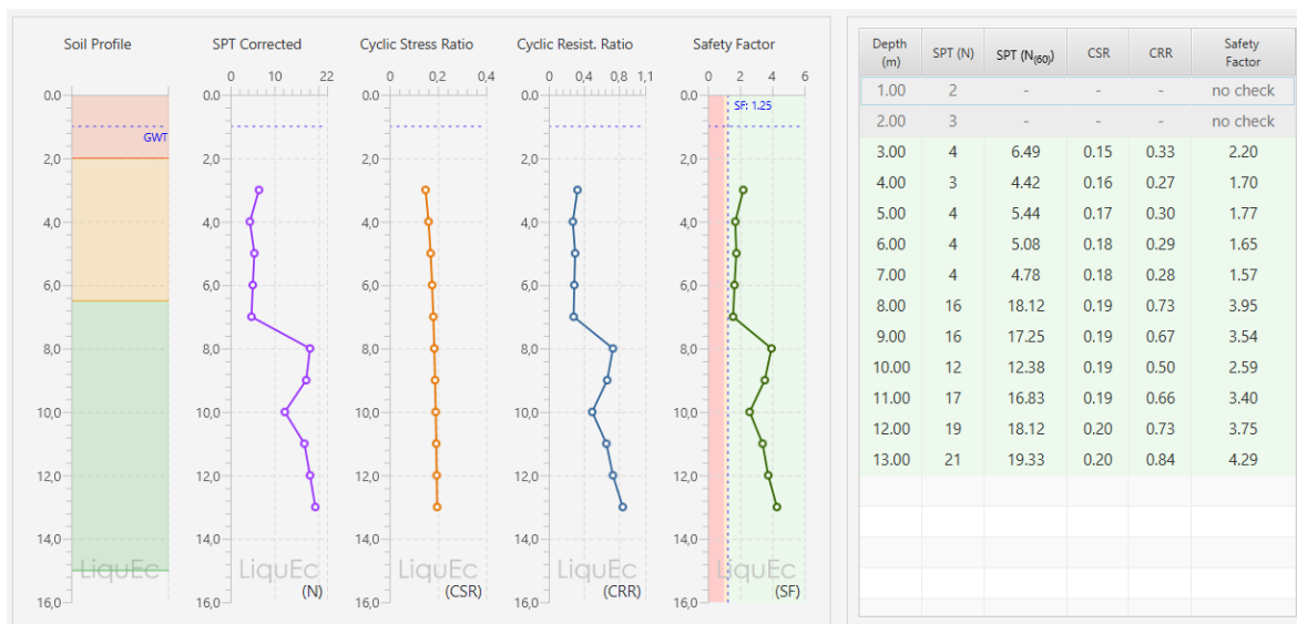
Figura 11. Análisis licuación perforación 18
